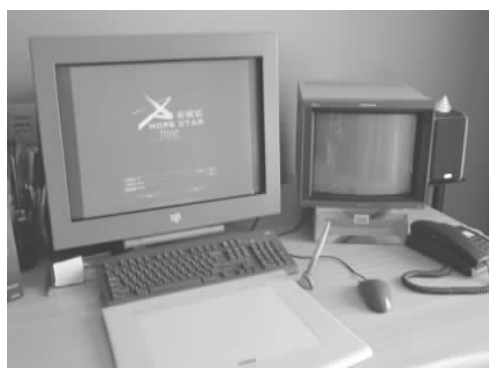
图 1-1-3 摇云创城非压缩非线性特技合成编辑系统 (由宏视达后期制作公司提供图片)
