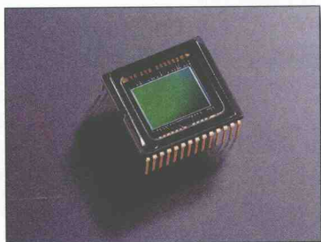
图 1.2 数码相机的 CCD 影像传感器
