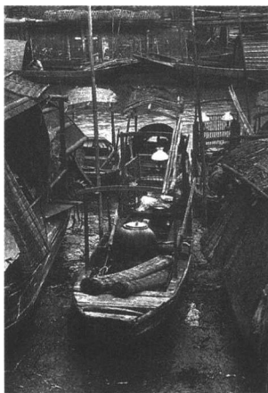
图 1.14 20 世纪 20 年代，广东地区的船只。由于渔民生活方式的限定，船只中的空间与用具都必须符合特定的功能要求。图中船只后部的围栅便是用来防止小孩活动时落水而特意设计的。
