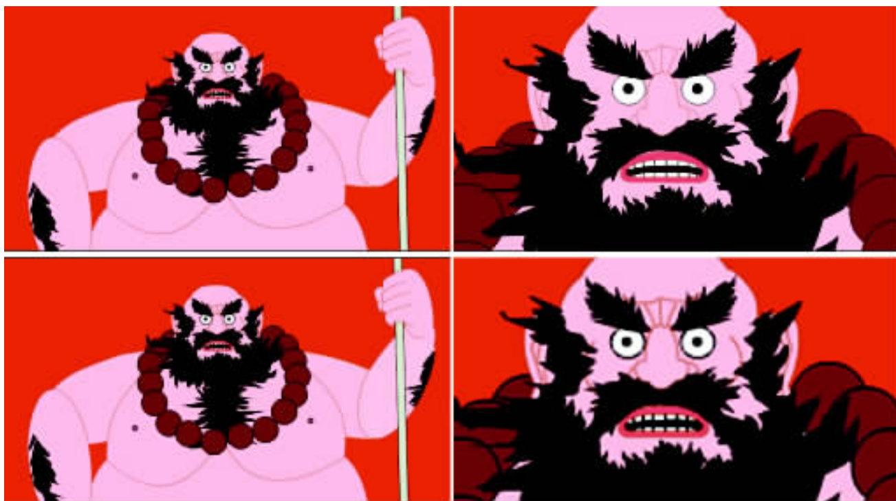
图1-9 上面矢量图缩放不影响画面品质,而下面位图缩放明显影响画面品质
