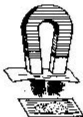
图1—8 用磁铁分离铁粉和硫粉
