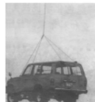
直径 6 mm 的尼龙绳吊起 2 t 重的汽车
