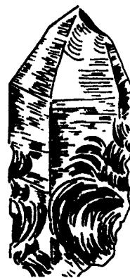
图 1-3 单晶石英的贝壳状断口
