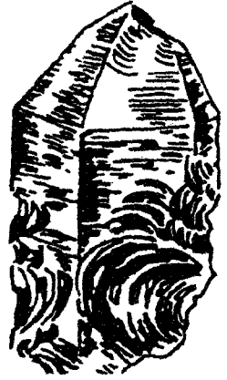
图 1-4 石英晶体贝壳状断口
