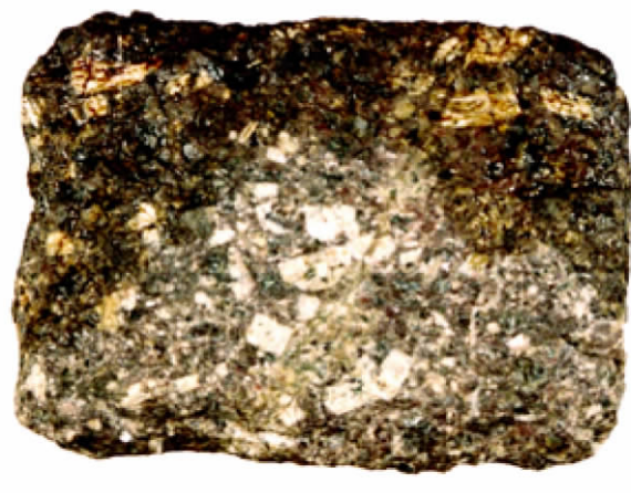
图 1-10 花岗斑岩的斑状结构 (大晶粒为斑晶,小晶粒为基质)
