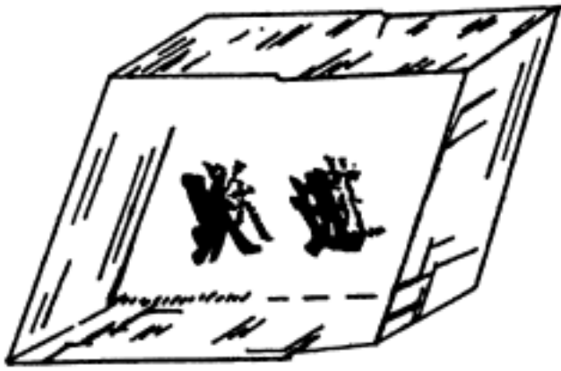
图 1.1.4 冰洲石的重折射现象
