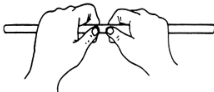
图 6 玻璃管的折断
