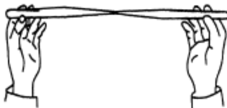
图 10 玻璃管的拉细
