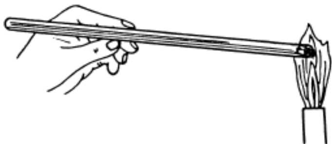
图 7 玻璃管截断面的熔烧
