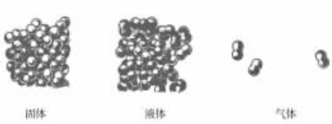
图 1-4 固体、液体、气体的分子间距离比较示意图(以碘为例)
