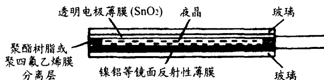
图 2-5 液晶显示装置的简单断面结构
