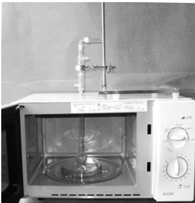
图 11-3 制备对氨基苯磺酸的实验装置图
