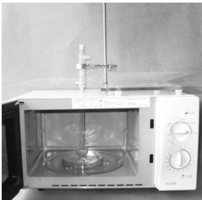
图 11-5 制备肉桂酸的实验装置图
