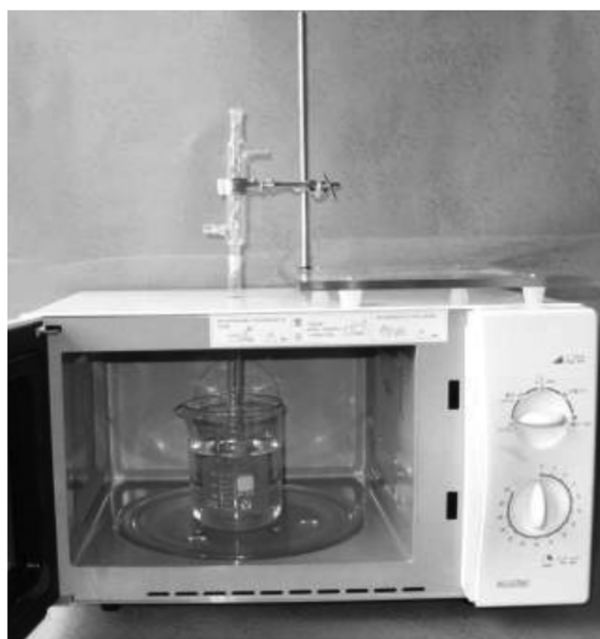
图 11-7 制备乙酸乙酯的实验装置图
