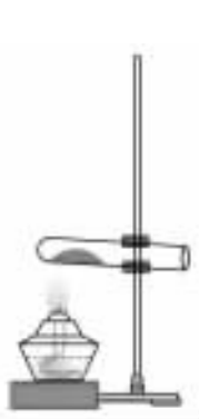
图 6 加热试管中的固体
