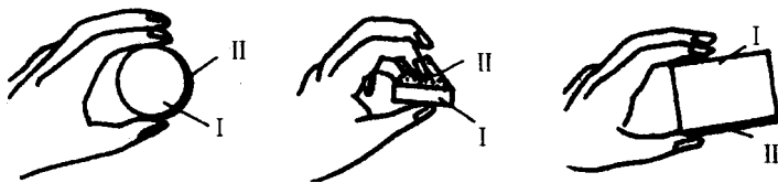
图2 手持光学元件的方式 I—光学面;II—磨砂面
