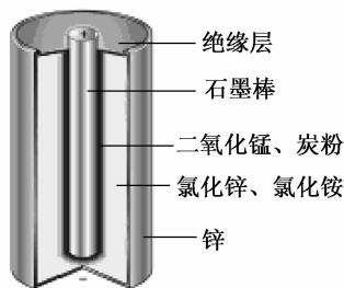
图 1.2-1 Zn-MnO 2 干电池剖面图
