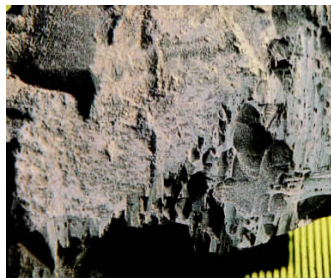
辽宁富产膨润土，它是由凝灰岩和其他火山岩经蚀变而成，吸水性强，体积能随吸水而胀大，极具工业价值。
