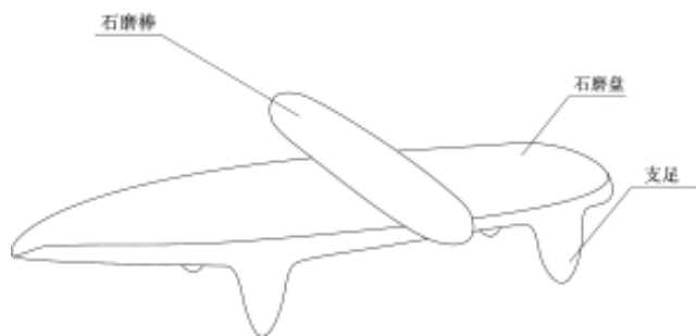
图二 磁山石磨具结构及名称示意图
