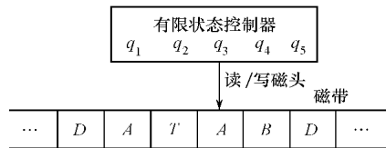
图1.2 图灵机的组成原理
