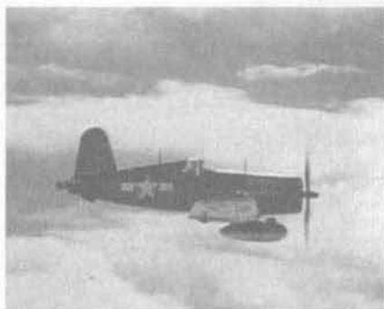
“海盗”机身前部的中轴线上有个178加仑的外挂油箱，可携带1000磅炸弹
