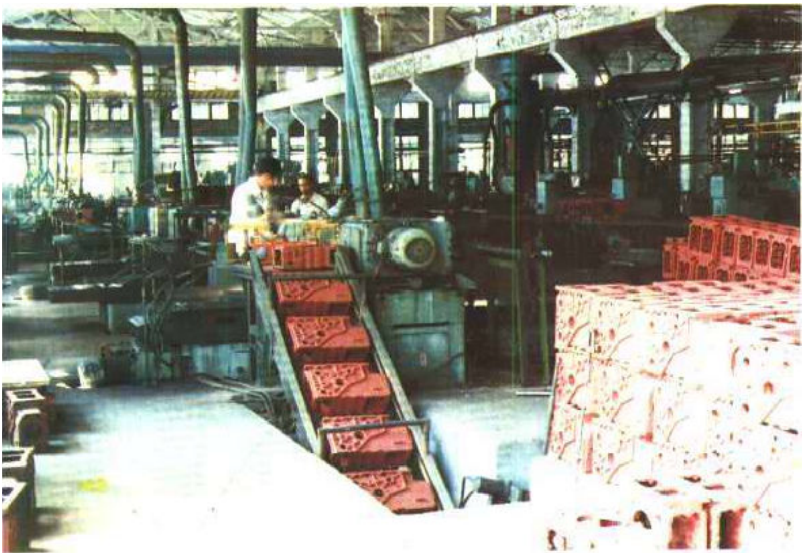
1958年，公私合营铁工厂转为国营企业，更名 为南宁机械厂。现为国家机械电子工业部的重点厂 之一。图为柴油机缸体加工流水线。
