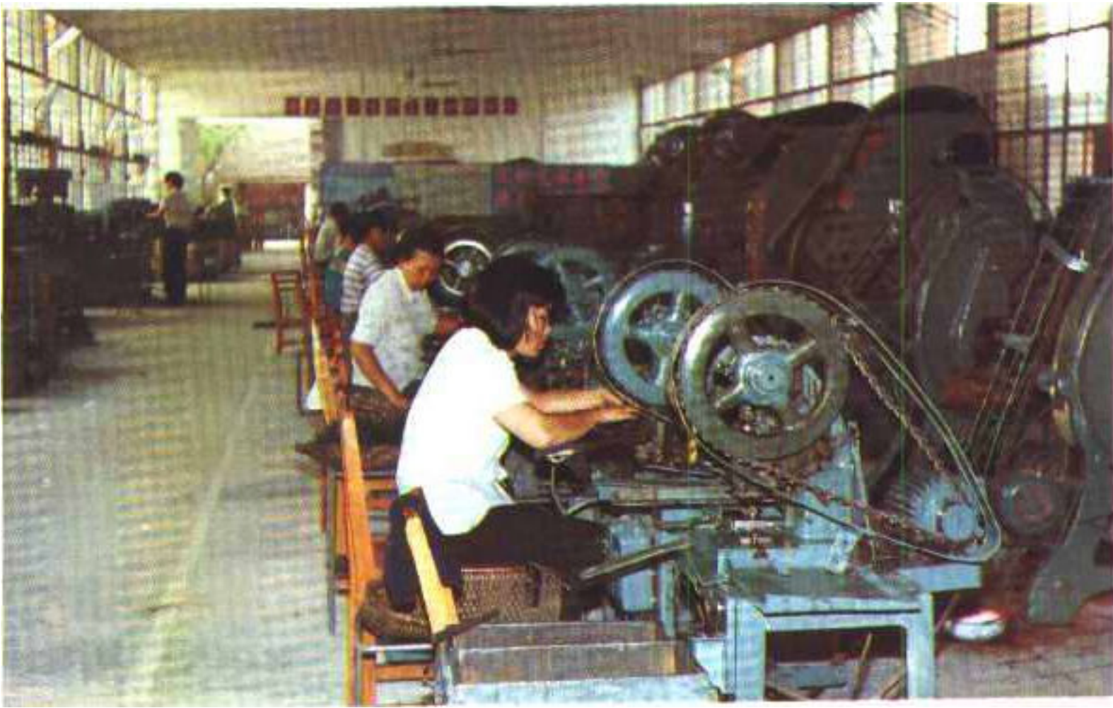
南宁市本记遮厂原是一间设备简陋的手工作坊。公私合营后，1967年易名为“南宁市伞厂”。图为伞骨车间工人正在冲压伞骨。
