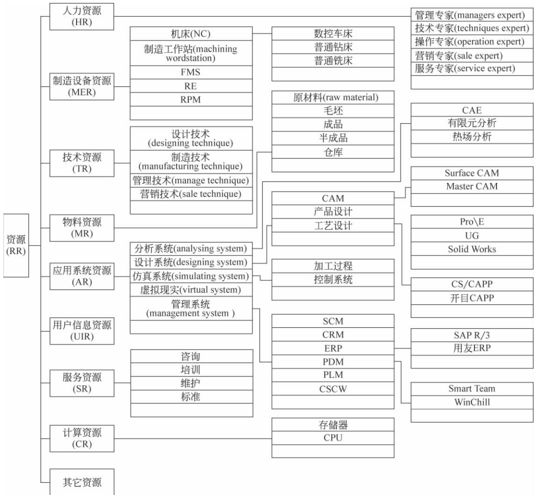
图 1-4 网络制造系统中的制造资源分类图 [10]
