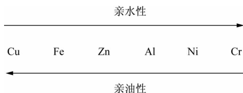
图 2-4 各种金属的亲水亲油性排序
