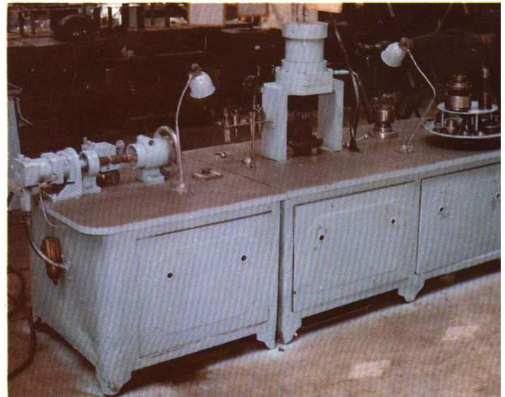
张家口汽车修理厂革新制造的差速器作业台
