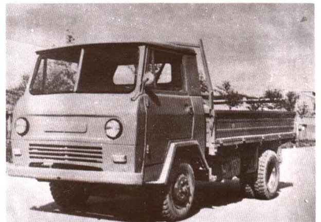
市交通局汽车修理厂自制的 295 型柴油车
