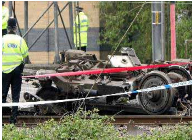
图 1-2-4 London 事故中被毁的车辆转向架
