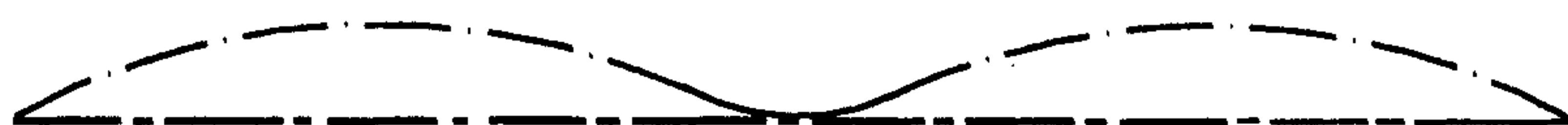
图 1-3 主轴颈轴线的弯曲变形图
