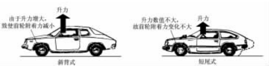
图 1-1-10 短尾式车身对横风较稳定的机理
