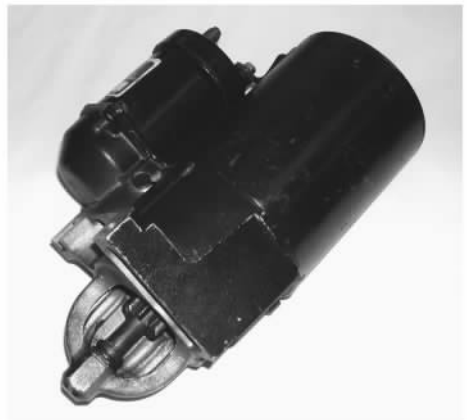
图 员-员 摇车用发动机上的起动电动机用来将电能转换成起动过程中转动发动机所需的机械能
