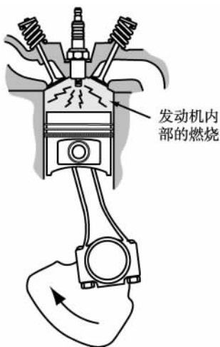
图 5-15 在内燃机内，汽油燃烧在发动机内部发生，直接与运动部件接触
