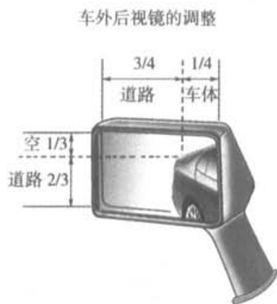
图 1-1-20 车外后视镜的调整
