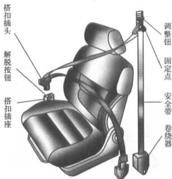
图 1-1-23 安全带的构造
