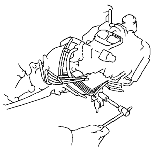
图 1-17 拆下 1 号空气管
