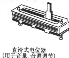
图 2-2 可变电阻的外形及符号
