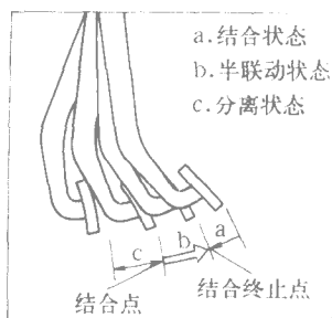
图 6 离合器工作状态示意二
