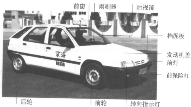
图 1 汽车外部机件示意一
