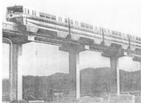
图3 跨座式胶轮单轨运载系统
