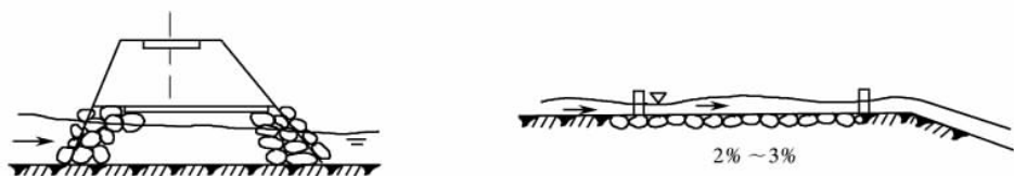
图 1-5 渗水路堤和过水路面
