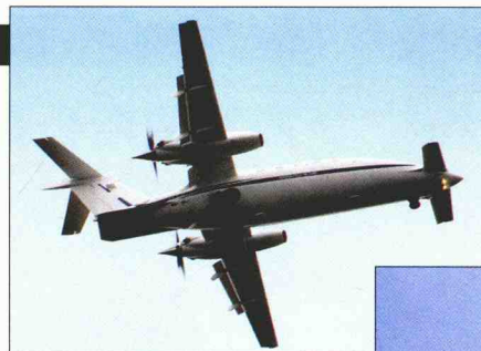
上图：每一个主起落架向后收入下部机身。机头的起落架向前收起，并有一对机轮。
