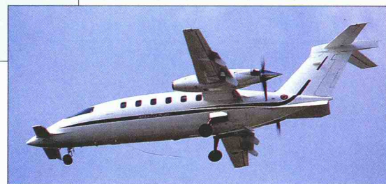
下图：巨大的襟翼安装在机翼后缘的弦外和弦内截面上。襟翼沿坚固表面分布。
