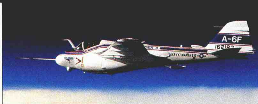
可取下的空中加油导管一般安装在机头雷达天线罩尾部中心线处。可以从KA-6D和其他软管装备的加油机加油。
