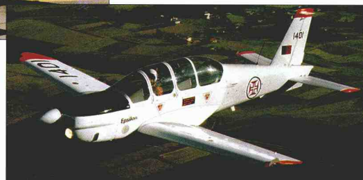
“厄普西龙”的机身采用轻铝半硬壳式构造。固定表面包着金属外皮,而升降舵和方向舵的表面是聚脂纤维。
