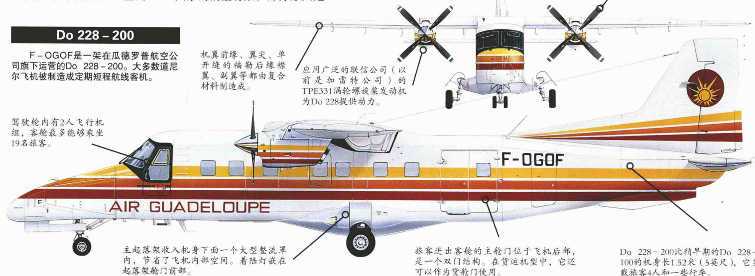
每一个发动机安装了一个4叶恒速全顺桨可逆桨距金属螺旋桨。
