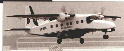
每一个发动机安装了一个4叶恒速全顺桨可逆桨距金属螺旋桨。
