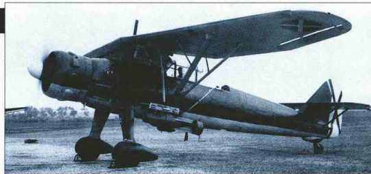
上图：一架Hs 126飞机正准备起飞，在其机身一侧可选的支架上装备有1枚50千克(110磅)的炸弹。这架飞机在西班牙获得了很好的战斗评价出动次数。
