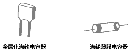
图 1-10 涤纶电容器的外形
