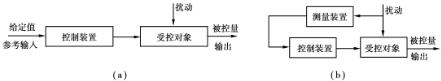
图 1.3 两种开环控制形式方框图
