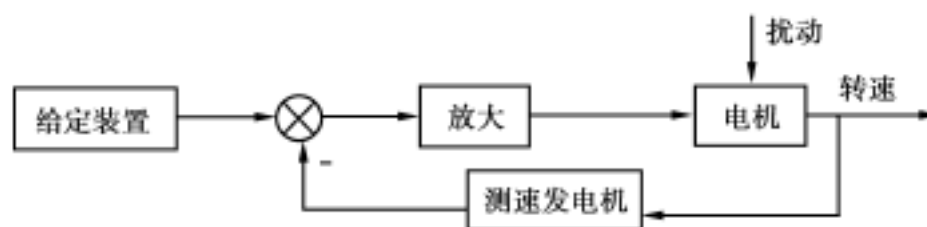
图 1.8 调速系统原理图
