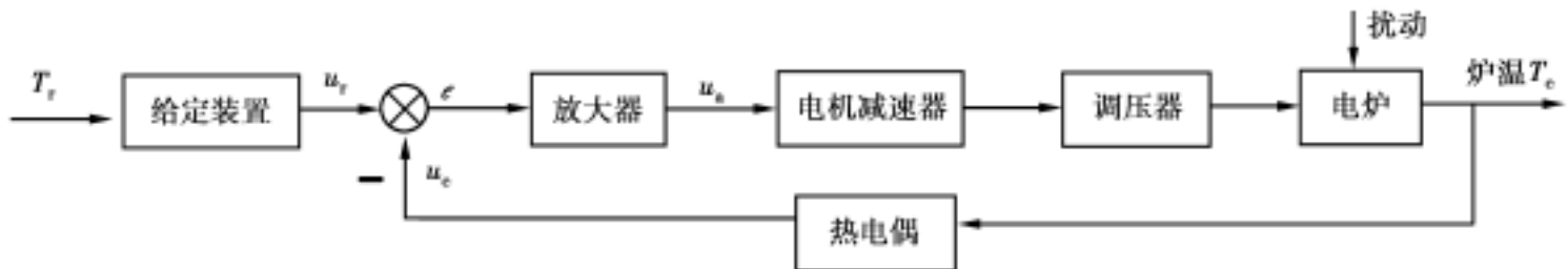
图 1.5 闭环控制的电加热炉方框图
