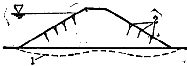
图 1-3 黄土地基不均匀湿陷引起的纵缝 1—黄土湿陷；2—纵缝
