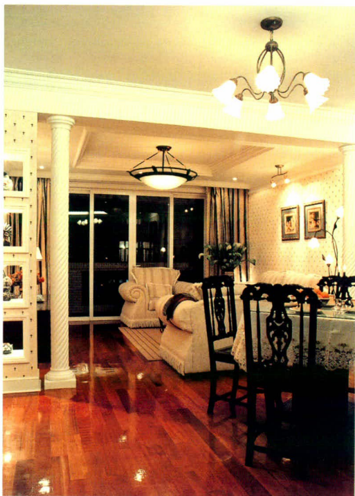
图1-1 在客厅中,休息区与餐厅是通过家具和照明予以分隔的。休息区中央结合吊顶造型布置间接型吊灯,光线由上反射而下,而餐厅则布置花瓣状直接型吊灯,增加就餐区的照度。此外,装饰凹龛的筒灯、照画的射灯均为辅助空间的局部配光。
