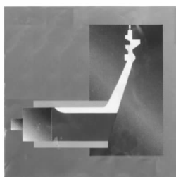
(a) 优化的热压室以特别准备过的高质量合金在低紊流下进行充型
