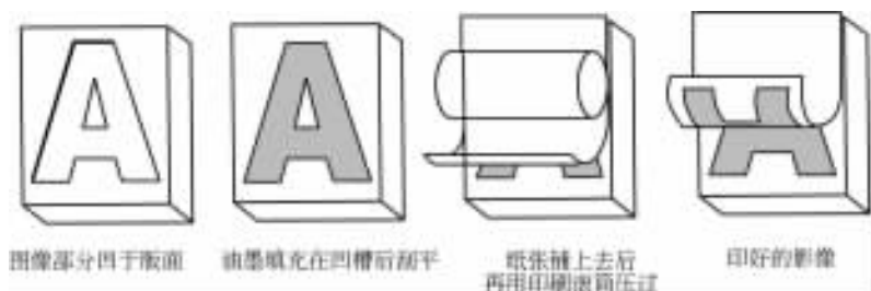
图 1-6 凹版印刷示意
