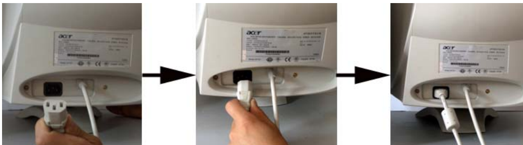
图 1-9 连接显示器电源线过程图
