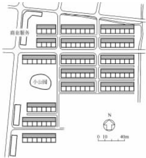
住宅区占地 3.26hm 2 ，规划居住 100 户、400 人。平面布局采用基本的行列式布置手法；商业服务设施沿路设置，结合池塘设立小花园。
