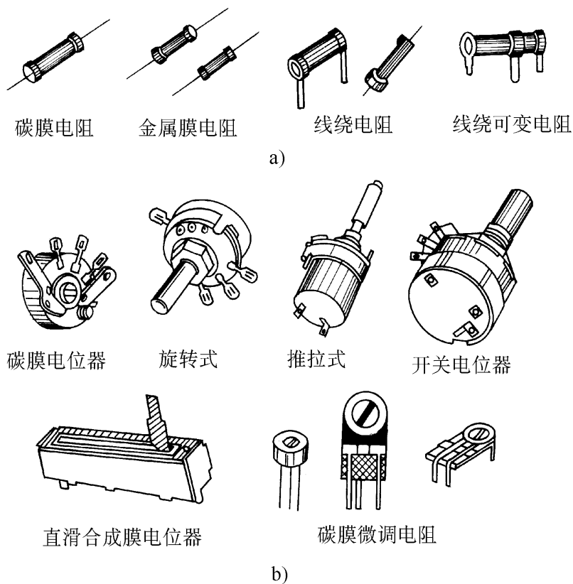
图 1-1 电阻器的种类及结构
