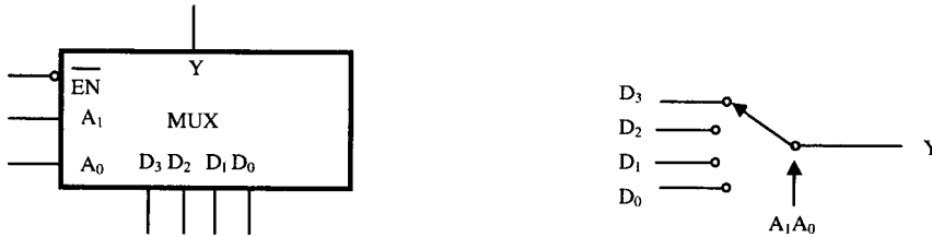
图 1.10 4 选 1 数据选择器的逻辑符号图 1.11 4 选 1 数据选择器等效电路图
